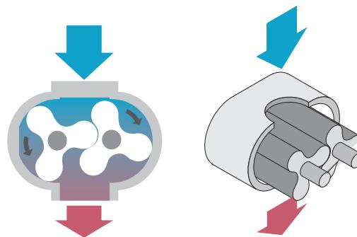
El soplante de émbolos rotativos se compone fundamentalmente de un estator dentro del cual se alojan dos émbolos simétricos, con forma de engranaje tridental que giran en sentido contrario y velocidad uniforme.
